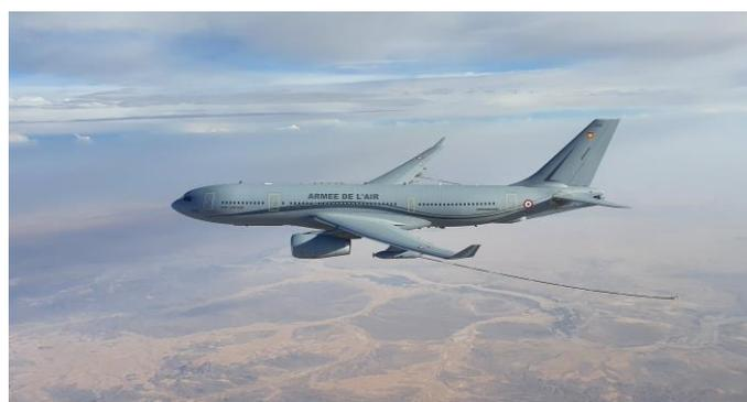
Disposant de deux configurations qui lui permettent d'effectuer simultanément du transport de troupes et de matériels ainsi que du ravitaillement en vol, il offre une capacité d'emport largement supérieure au C135, apportant ainsi une plus-value significative à la conduite des opérations aériennes en BSS.
